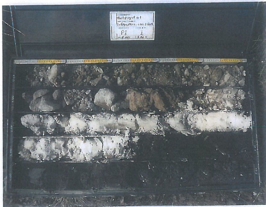
Sondaggio P1: cassetta n° 1, da 0.00 m a 5.00 m.
