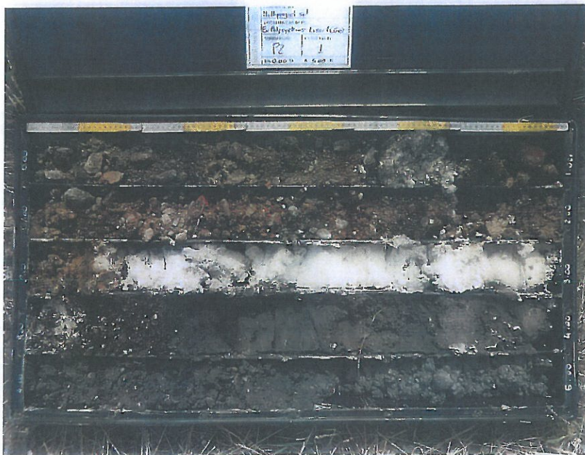
Sondaggio P2: cassetta n° 1, da 0.00 m a 5.00 m.
