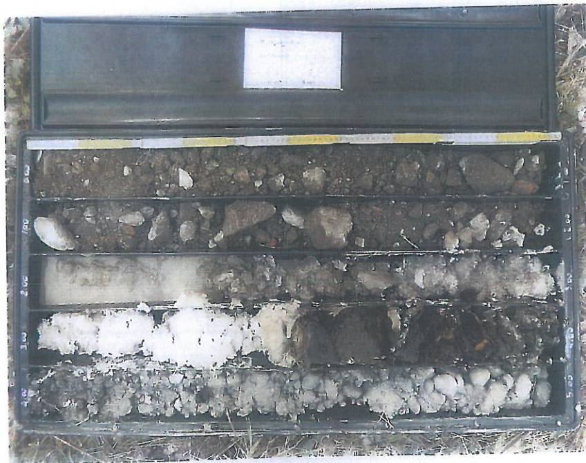
Sondaggio P4: cassetta n° 1, da 0.00 m a 5.00 m.
